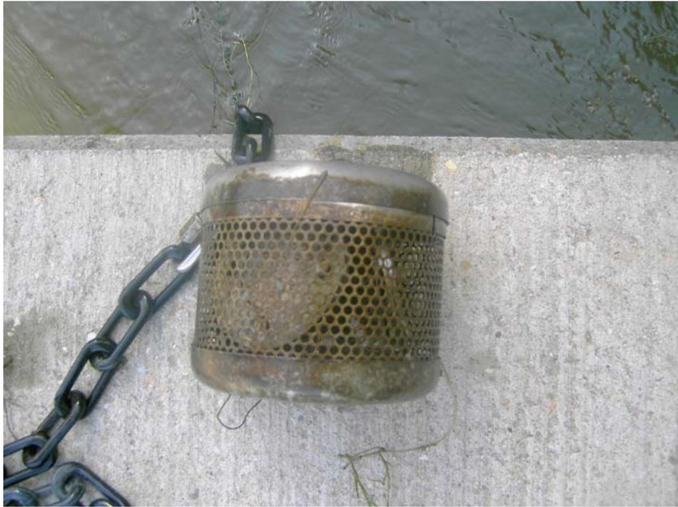
*Abbildung 11: Detail des Passivsammlers an der PNF Saale in Wettin nach einem Monat Exposition.*
