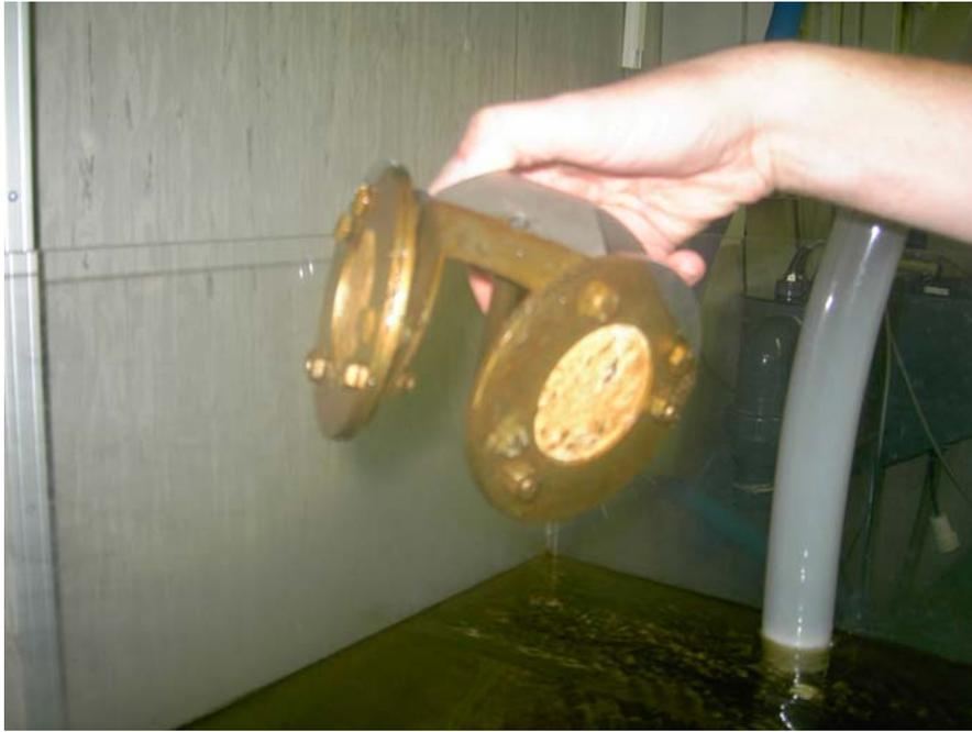
*Abbildung 7: Passivsammler an der PNF Mulde in Dessau nach einem Monat Exposition.*
