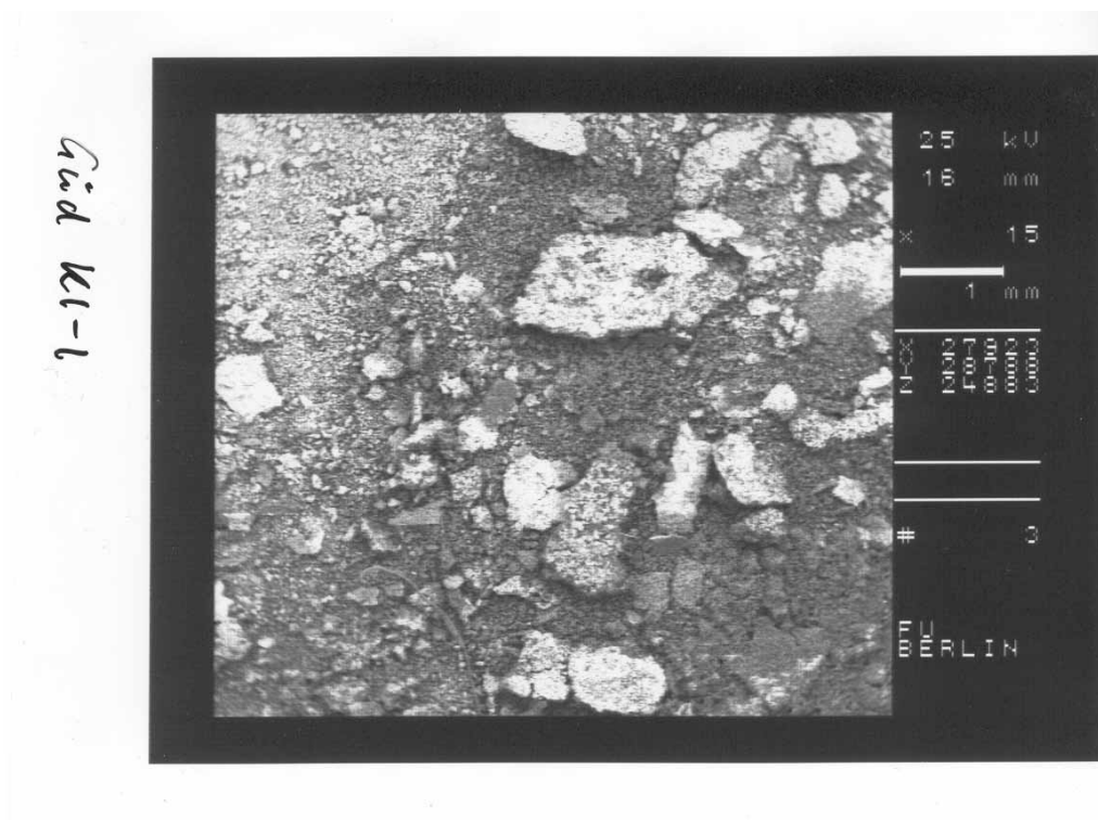
Abbildung 5-1: SEM Güd K1-1: Es sind amorphes Material, Plättchen und einige mm lange Fasern zu erkennen (siehe Detail Abbildung 5-2)
