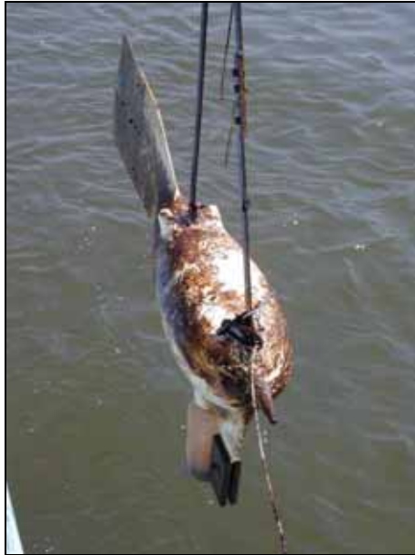
Foto 8-3: Schwebstoffsammler „BISAM“ der BfG (Foto: W. Rätz, BfG, 2005)
